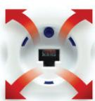
Iekārtu savienojumi ir izstrādāti tā, ika pat ja kabelis tiks izrauts nepareizi, tad savienojums tiks atvienots no ligzdas, neskatoties uz tā pozīciju (skatīt zemāk). Tas pasargā kabeli, pults savienojumu un ligzdu no saplišanas. Notiks pults atvienošanas trauksme. Pulti var savienot atpakaļ ligzdā, jebkurā brīdī.
